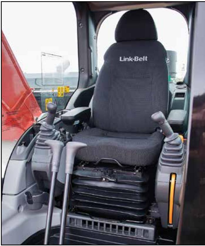
La cabina de la serie X3E de Link-Belt es la más resistente y espaciosa de todos los modelos ofrecidos previamente y está certificada como norma ROPS y FOPS estándar nivel 1, diseñada para garantizar durabilidad sin reducir la comodidad del operador. Visibilidad optimizada en todas las direcciones.
