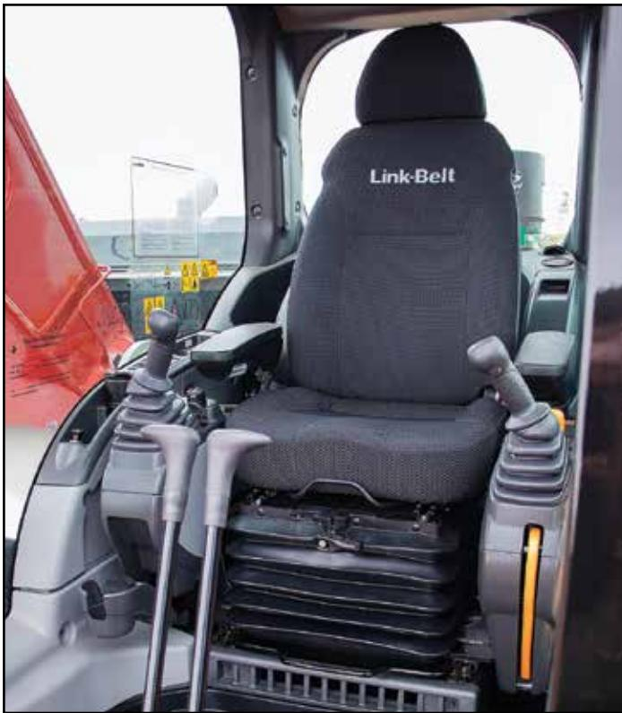
La cabina de la serie X3E de Link-Belt es la más resistente y espaciosa de todos los modelos ofrecidos previamente y está certificada con ROPS y FOPS Nivel 1 estándar, diseñada para asegurar durabilidad sin reducir la comodidad del operador. Visibilidad optimizada en todos los sentidos.
